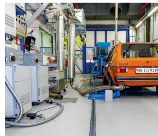
VW Golf GLS von 1978 bei den Leistungs- und WLTP-Abgasmessungen bei der EMPA.
