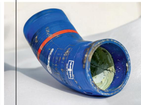
Ablagerungen durch ungeeignete Kühlmittel oder Kalk führen zu Schäden.
