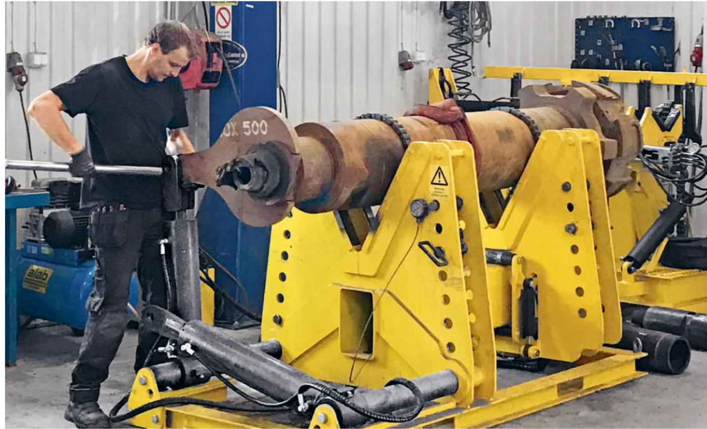
Bis zu 30 Tonnen Kraft überträgt das Hydraulikfluid beim Löseprozess auf die Verschraubung.
