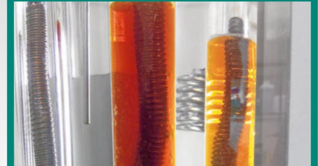
Der trockene [ohne Wasserzugabe] TOST verwendet eine Oxidationszelle aus Glas. Darin wird eine Probe des Testöls zusammen mit einem Katalysator platziert und auf 95 °C erhitzt. Der Probe wird zudem laufend Sauerstoff zugeführt. Das Resultat wird in Stunden angegeben und widerspiegelt die Oxidations-Lebensdauer des Öls bis zur definierten Versäuerung. ISO 4263-3/DIN 51554-3
