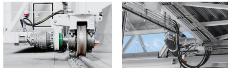
Mit insgesamt vier Hydromotoren (zwei unten und zwei oben) wird der Landesteg exakt längsseitig auf die Position des Passagierausgangs gebracht.
