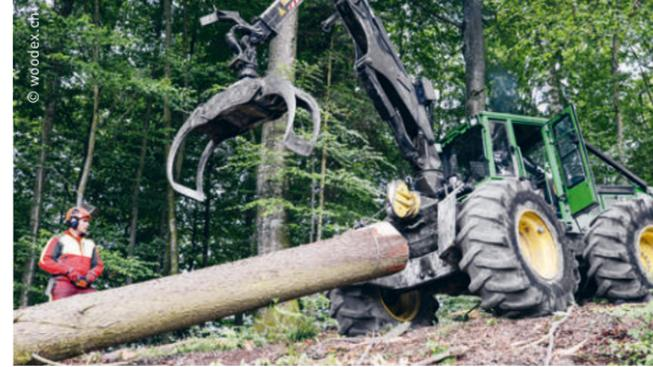
Effizient: Das «Rücken» wird fernbedient von einer Person durchgeführt und das Zugseil lässt sich per Funk entriegeln.
