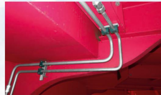
Beinahe 420 Meter Hydraulikleitungen wurden in der Werft auf der Seerose verlegt.
