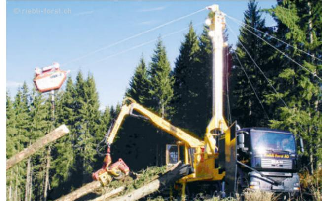
Schonender Maschineneinsatz: Vor allem Seilwinden und Seilgeräte kommen im steilen und unwegsamen Gelände zum Einsatz.
