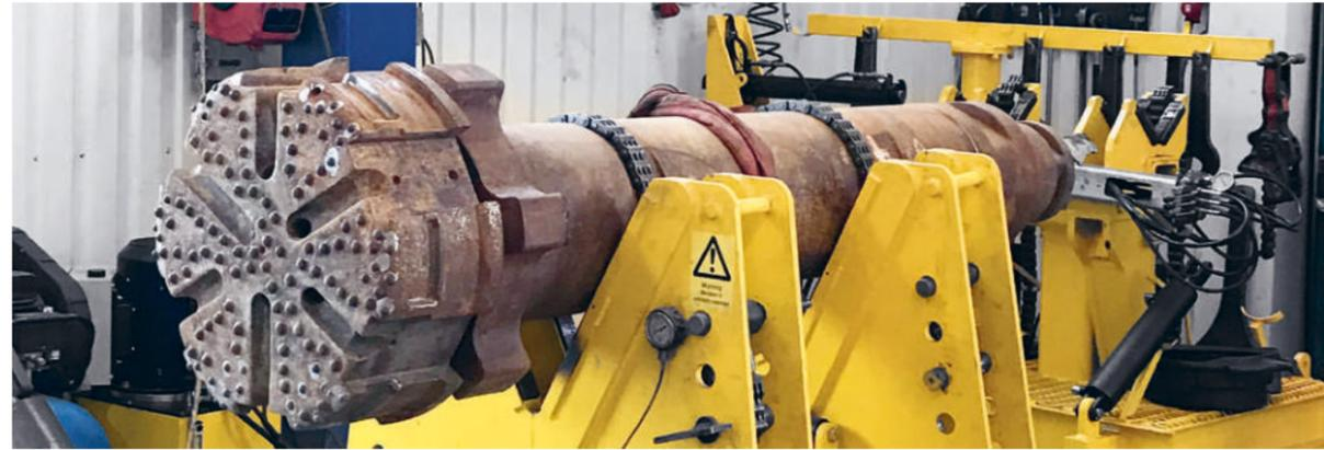
Selbst fest verschraubte Bohrköpfe lassen sich einfach per Knopfdruck lösen.
