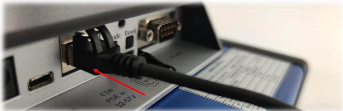
4. Schließen die Stromversorgung des GSM-Router an
